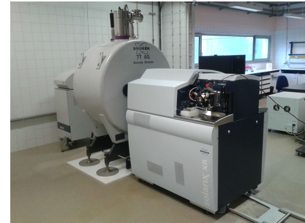
FT-ICR-MS, mit Magnet aus supraleitender Spule an der Uni Lisboa; Quelle: www.eu-fticr-ms.eu (Apr2021)
