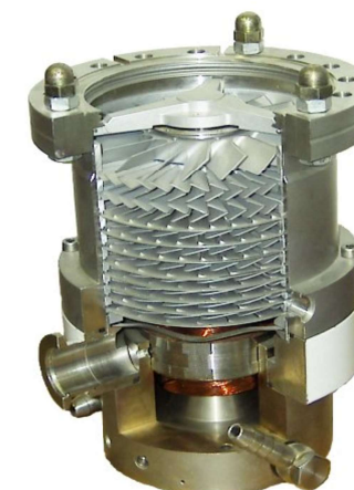
Turbo(molekular)pumpe Quelle: wikipedia.de; User:Liquidat
